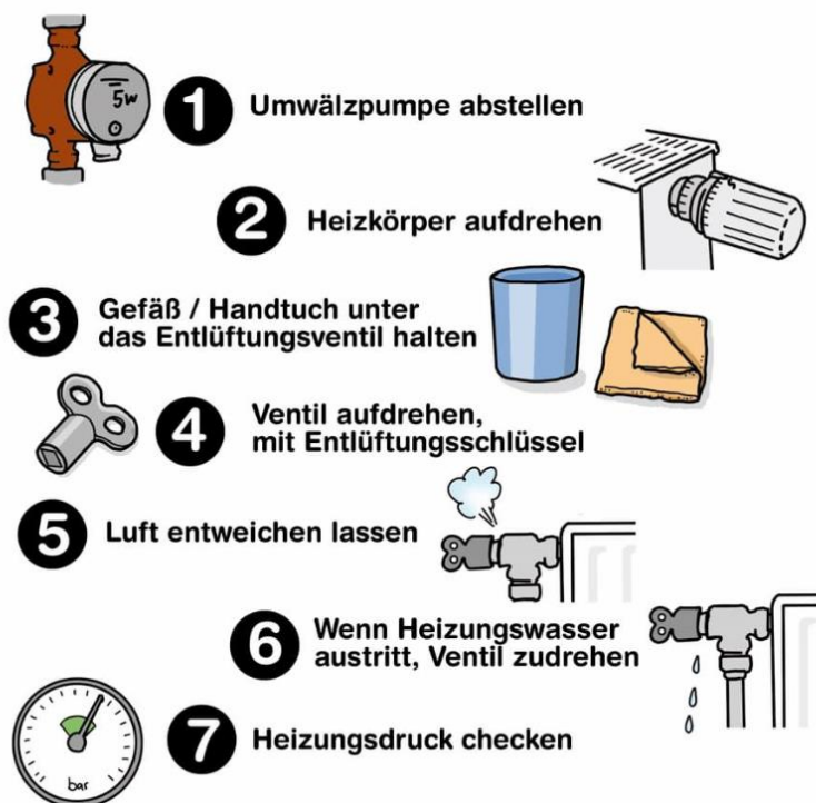
Abbildung 3: Heizung entlüften Schritt für Schritt (Bildquelle: heizsparer.de )
